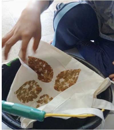
Gambar 5 Proses pencelupan kain dengan larutan tawas agar pigmen daun melekat sempurna dan tidak mudah luntur
