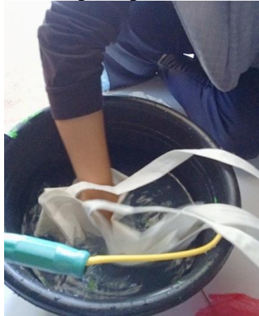
Gambar 2 Santri melakukan proses pencelupan totebag di larutan tawas bertujuan agar pigmen daun melekat dengan baik pada pori-pori kain Sumber: Dokumentasi pribadi, 3 Oktober 2021.
