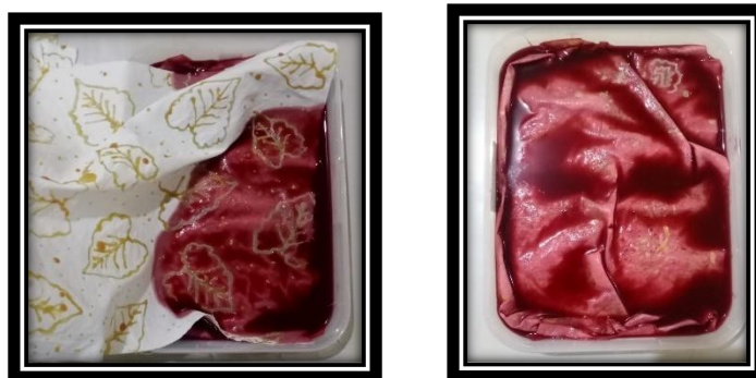
Gambar 4. Perendaman kain ke dalam larutan pewarna daun jati selama 1-3 hari
