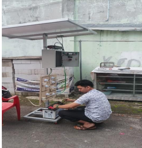
Gambar 9. Test pengisian accu dengan PV
