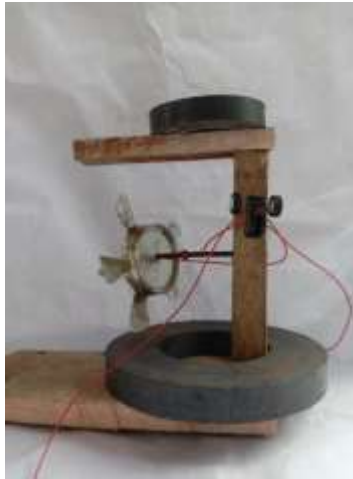
Gambar 3. Rangkaian Magneto Electrical sebelum dipasang lampu
