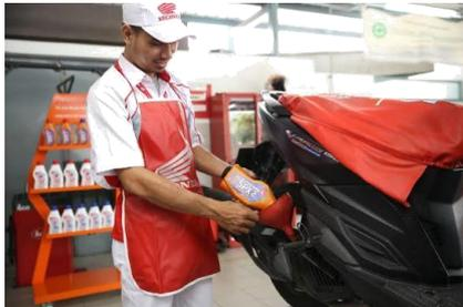
Gambar 1. Postur Kerja Penggantian Oli Setelah Perbaikan
