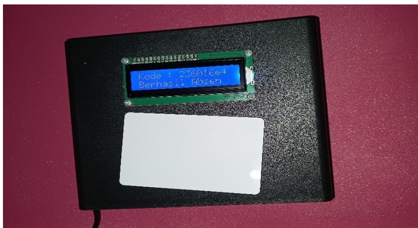
Gambar 9. Kartu RFID terhubung dengan RFID Reader (Sumber: Peneliti 2024)
